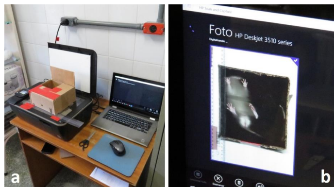
234 Figura 3. Aquisição das imagens através do escaneamento das pegadas. 235 a) Caixa sobre o scanner acoplado ao notebook. b) Imagem digitalizada 236 na tela do notebook. Fonte: Autor.
