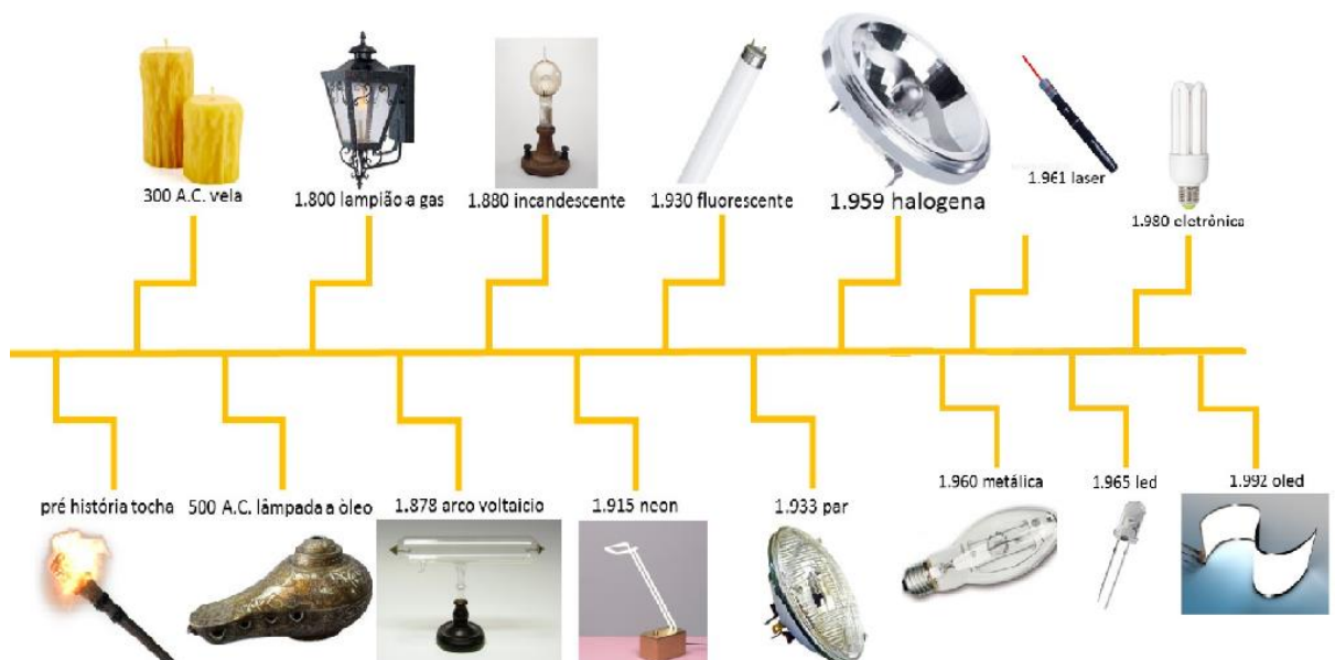
Figura 1 - Hierarquia do desenvolvimento da iluminação.
