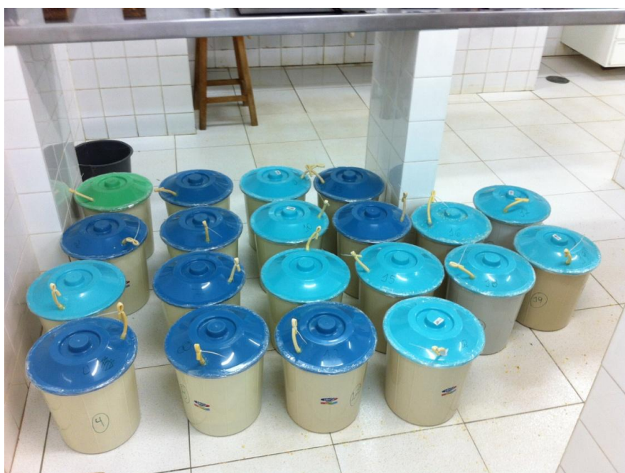
Figura 1. Silos experimentais utilizados para a ensilagem dos grãos de milho. 13/12/2012 Universidade Norte do Paraná.
