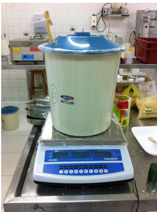
Figura 3. Pesagem do silo experimental pronto, após vedação. 13/12/2012 Universidade Norte do Paraná.
