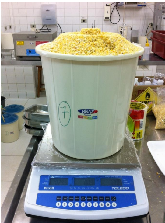
Figura 2. Pesagem do silo experimental finalizado, antes da vedação. 13/12/2012 Universidade Norte do Paraná.
